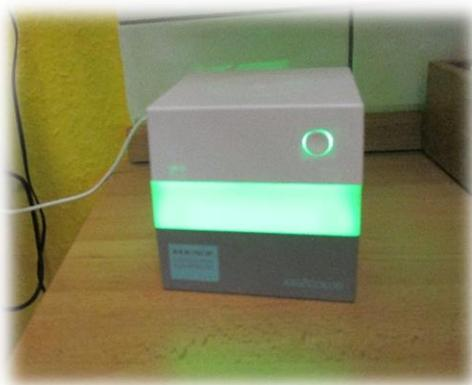
Nach einer Testphase in ausgewählten KiTas des Kita Zweckverbandes hat der Träger sich für eine Anschaffung von CO2-Ampeln für all seine Einrichtungen entschieden. Diese Ampel zeigt anhand verschiedener Farben an, wie belastet die Raumluft aktuell ist, und regt zum Lüften, entsprechend der angezeigten Werte, an. Nun freuen wir uns,
